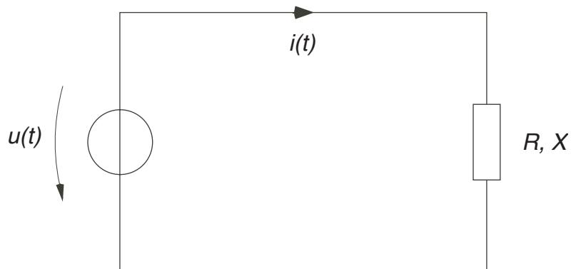
Calculer les puissances apparente, active et réactive absorbées ou produites par le système ( $R, X$ ). En déduire la réactance  $X$  (indiquer si elle est capacitive ou inductive) et  $R$ .
